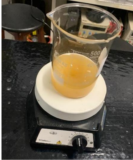
Figura 12 Solução de NaOH 0,1 mol/L sob agitação magnética. Fonte: Autor, 2024
