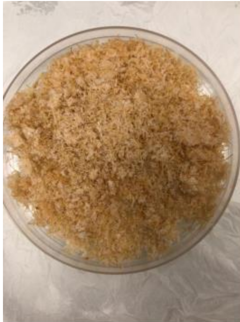
Figura 20 Polpa após tratamento com NaOH. Fonte: Caetano Gonçalves, 2021.
