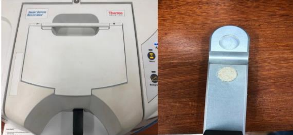
Figura 17 (A) Thermo Scientific Nicolet ISTM10 FT-IR Spectrometer. (B) Acessório de Refletância Difusa do Infravermelho com Transformada de Fourier (DRIF). Fonte: Caetano Gonçalves, 2021.
