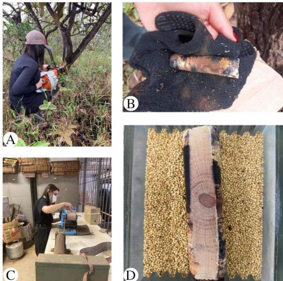
Figura 6. Processo de coleta e de preparo da amostra lixada. (A) Coleta com o perfurador. (B) Amostra recém coletada. (C) Processo de lixamento. (D) Amostra após lixamento. Fonte: Dr. a Clarissa Fontes.
