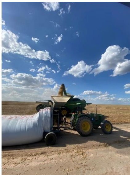
Figura 10 – Embutidora acoplada ao trator, recebendo soja da colheitadeira
