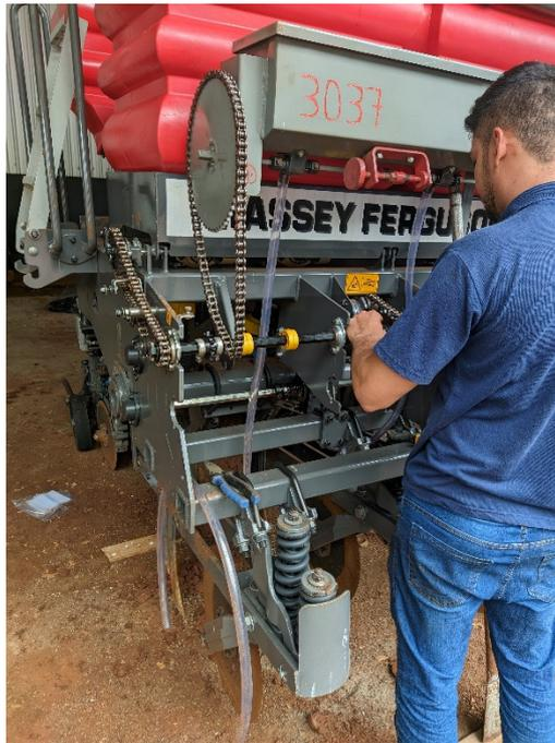
**FIGURA 3** - Assistente técnico Alam realizando a regulagem da plantadeira Massey Ferguson MF 517 H45 à vácuo de 15 linhas.
