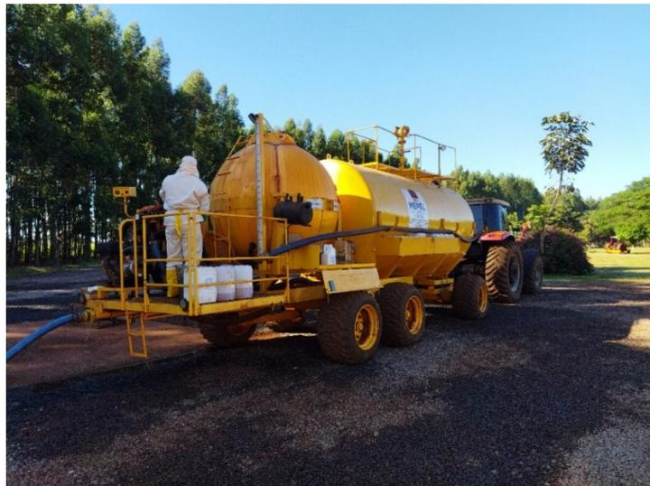
**FIGURA 12** - Dosador fazendo uso do tanque misturador Mepel.
