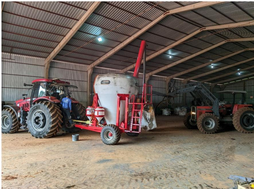
**FIGURA 5** - Disposição dos maquinários e equipamentos para grafitagem das sementes.
