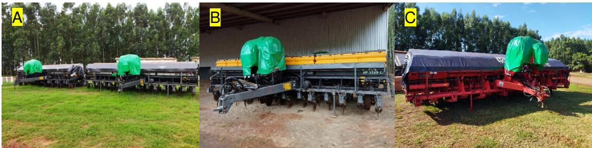
**FIGURA 2** - Plantadeiras Massey Ferguson MF 517 H45 à vácuo de 15 linhas (A); Plantadeira Valtra HiTech BP 1709 CF à vácuo de 15 linhas (B); Plantadeira Kuhn PDM PG 1700 mecânica de 15 linhas (C).
