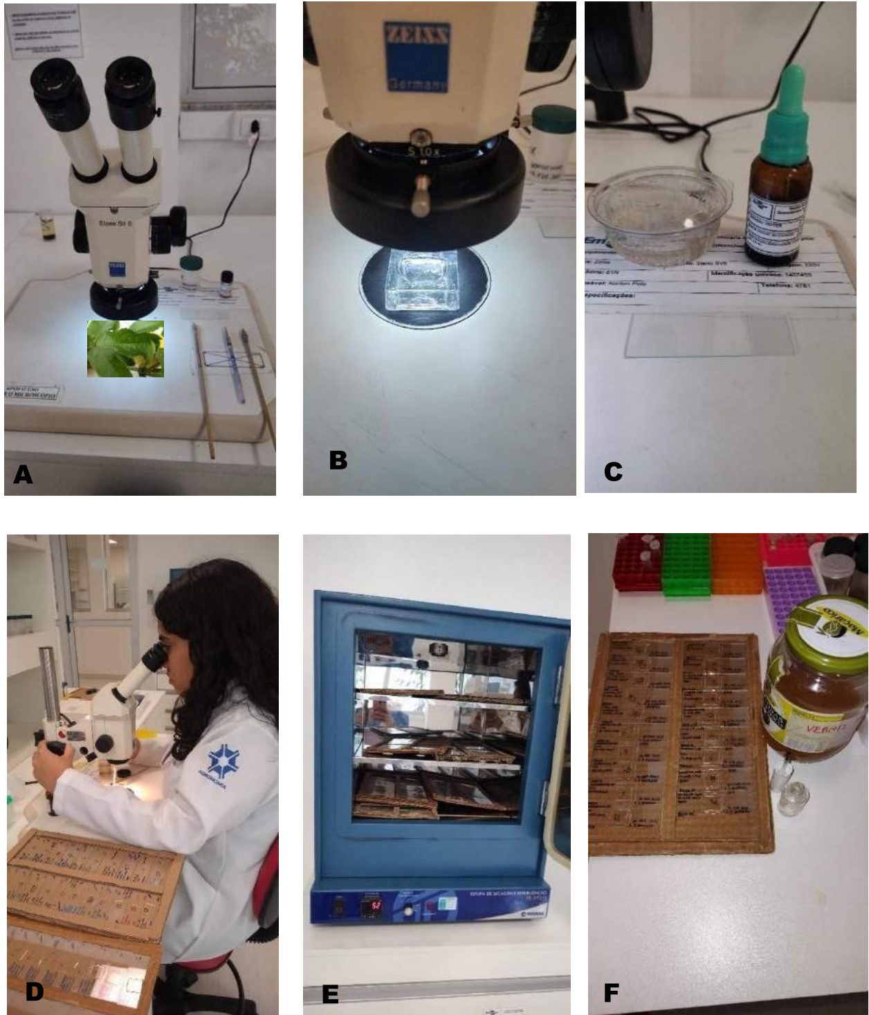
Figura 3. A. Inspeção acarológica de material vegetal ao microscópio estereoscópio; B. Inspeção da solução de álcool a 70% obtida após a lavagem e peneiramento do material vegetal; C. Detalhe do meio Hoyer utilizado para a montagem das lâminas; D. Rotina de inspeção, captura e montagem com o auxílio do estereoscópio; E. Estufa utilizada para a secagem do meio Hoyer de clarificação dos espécimes preparados em lâminas de microscopia; F. Lâminas retiradas da estufa e verniz utilizado para a selagem das lamínulas.
