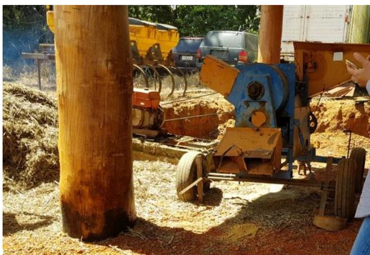
**Figura 9** - Maquinário utilizado para a debulha das espigas.
