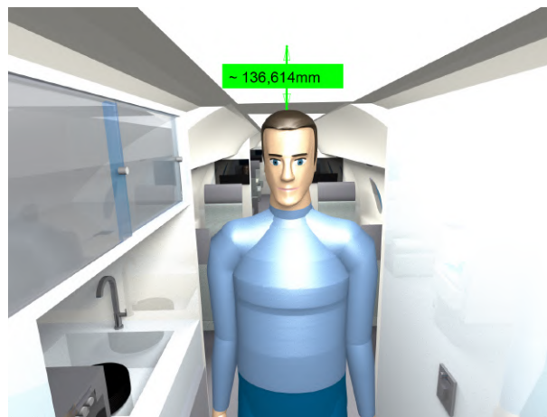
Figura 153 – Distância da cabeça do percentil 95 até o teto da galley. Fonte: Do Autor
