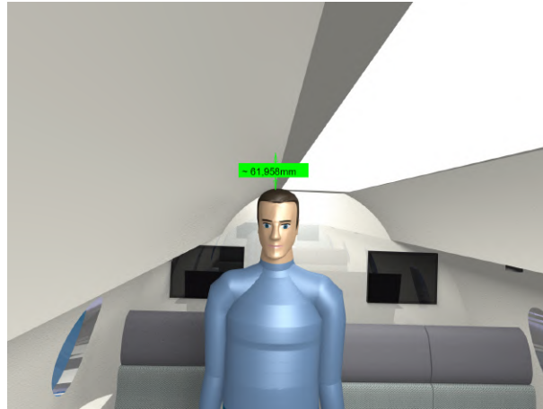
Figura 156 – Distância da cabeça do percentil 95 até o teto da seção 3. Fonte: Do Autor
