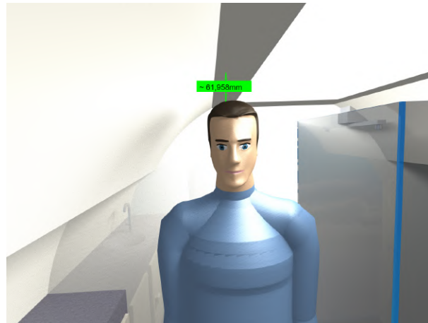
Figura 157 – Distância da cabeça do percentil 95 até o teto do banheiro. Fonte: Do Autor
