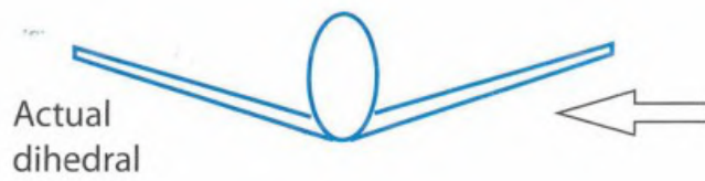
Figura 58 – Asa teórica com o diedro positivo. Fonte: (RAYMER, 2018).
