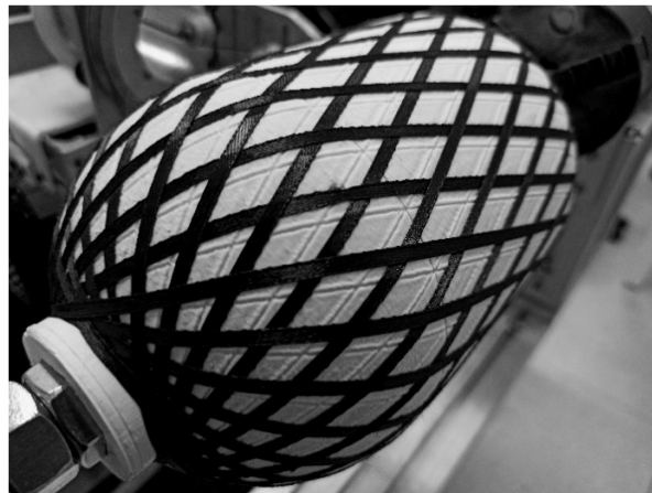
Figura 1 – Exemplo de padrão de deposição de fibras sobre a superfície de um mandril cilíndrico com domos elípticos. Fonte: ( ANDRIANOV et al., 2022 ).
