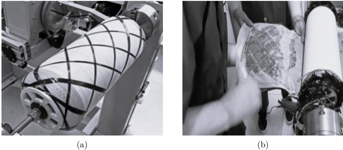
Figura 19 – Processo de fabricação dos corpos de prova planos [\pm 45^\circ]_n . a) Deposição do filamento sobre o mandril cilíndrico; b) Remoção do laminado da superfície do mandril. Fonte: (PIMENTEL et al., 2024)
