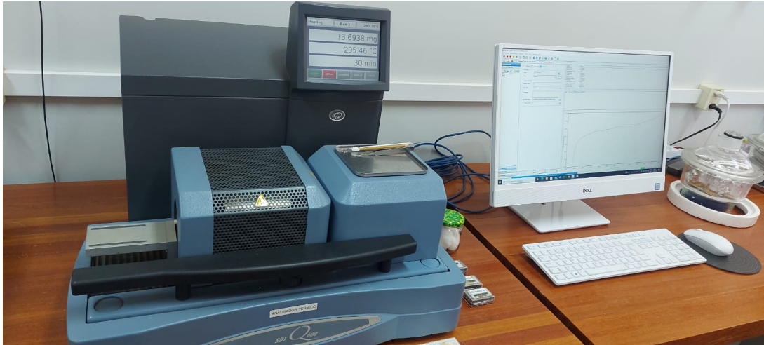
Figura 5.4 – Equipamento usado no ensaio de DSC/TGA Fonte: Autor.
