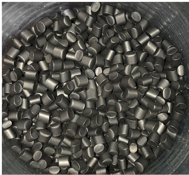
Figura 6.1 – Pellets de ABS com Pó de Titânio. Fonte: Autora.
