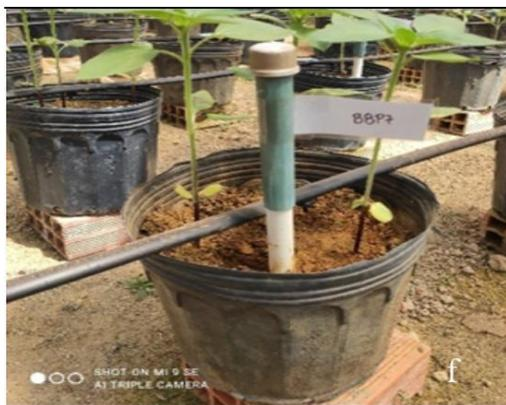
FIGURA 6. Tensiômetro instalado no tratamento B8P7, para acompanhamento do potencial matricial.
