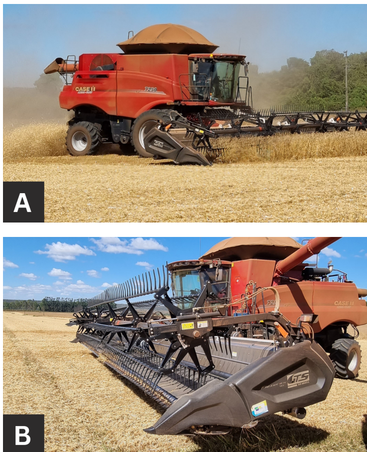
Figura 14. A) Colheitadeira Case IH Axial-Flow 7250 realizando a colheita do trigo BRS 404, no dia 22/06/2023. B) Plataforma de corte Flexer XS 40 GTS, 12 metros de comprimento.
