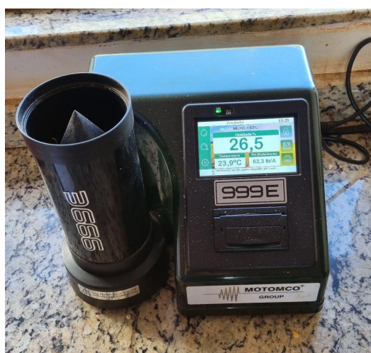
Figuras 12. Medidor de umidade Motomco 999E medindo a umidade dos grãos de milho do ensaio realizado no dia 05/07/2023.
