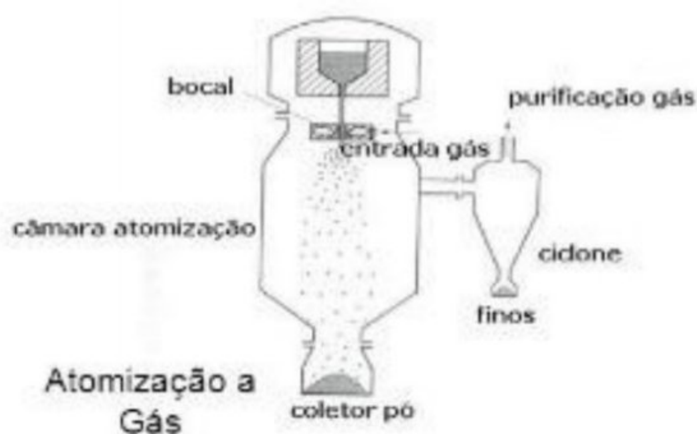
Figura 9 – Processo de atomização a gás – Fonte: (SLYDEPLAYER, 2023).
