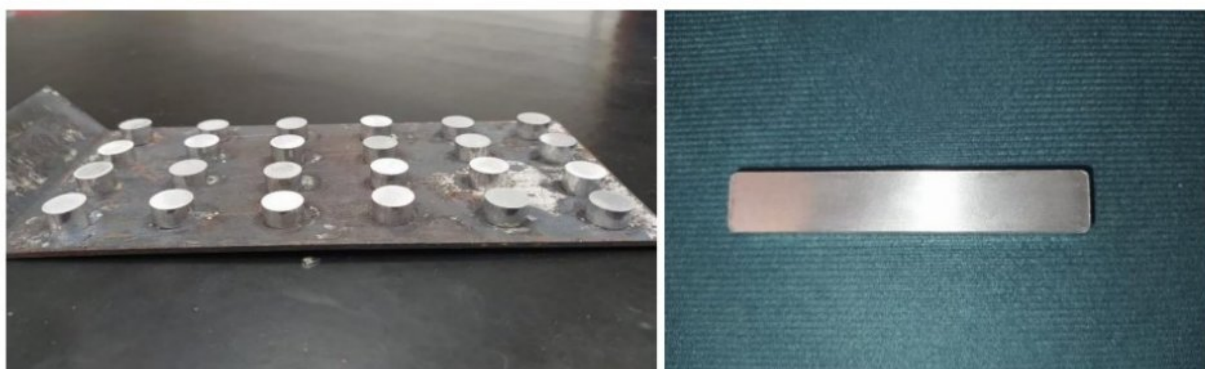
Figura 18 – Corpos de prova sinterizados utilizados na pesquisa, onde, à esquerda, têm-se os corpos de prova cilíndricos, e, à direita, os corpos de prova retangulares – Fonte: Reprodução própria.
