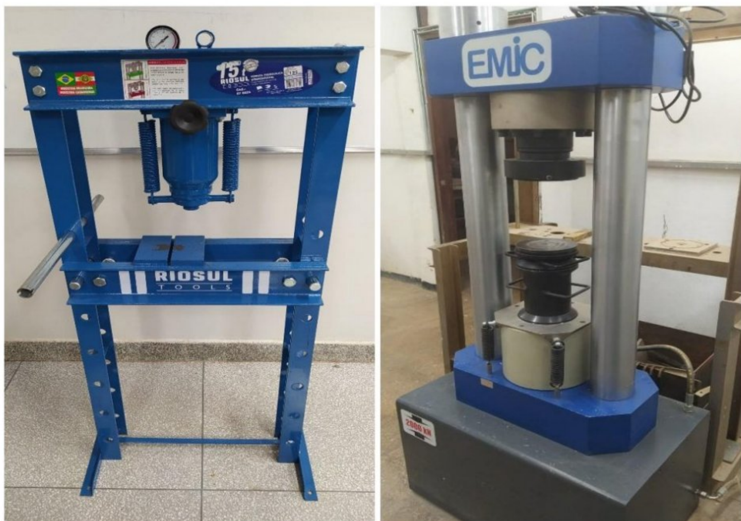
Figura 16 – Prensas utilizadas nas compactações, onde, à esquerda, tem-se a prensa de 15t da marca Rio Sul TOOLS empregada na pesquisa, e, à direita, tem-se a prensa de 200t da marca EMIC – Fonte: Reprodução própria.
