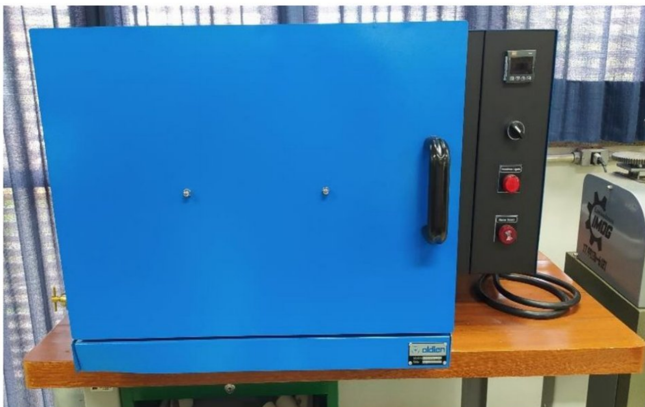
Figura 19 – Forno tipo mufla FEHE-36L-KM5 da marca Aldien, onde se deram as sinterizações na pesquisa – Fonte: Reprodução própria.
