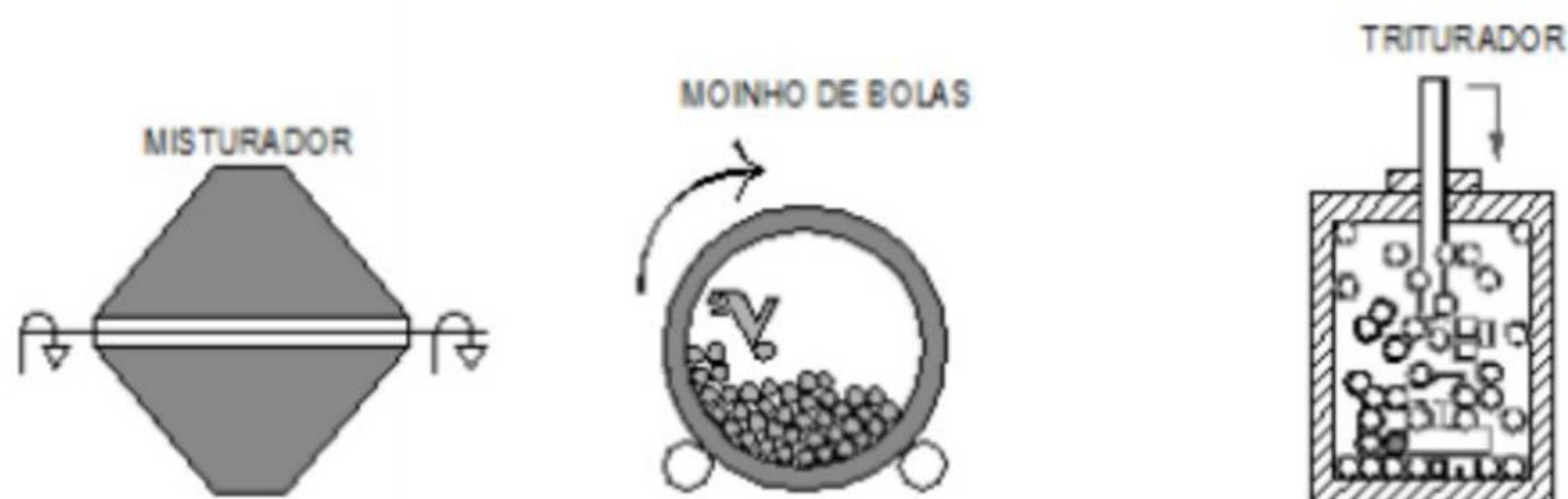
Figura 5 – Ilustração dos processos envolvidos na moagem de alta energia – Fonte: (TORRALBA; COSTA; VELASCO, 2003).
