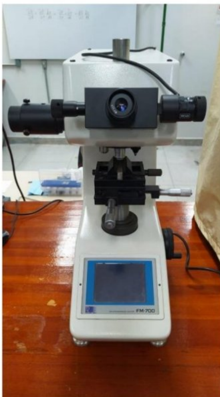
Figura 21 – Microdurômetro utilizado nos ensaios de microdureza Vickers na pesquisa – Fonte: Reprodução própria.
