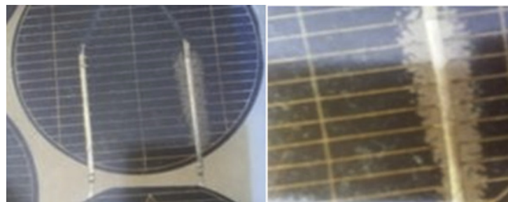
Figura 6 – Delaminação na interface do painel solar e nas interconexões das células fotovoltaicas (CHANDEL et al., 2015)
