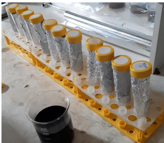
Figura 10. 1 grama de TFSA em tubos de centrífuga de 50 mL com 25 mL da solução de \text{KMnO}_4 para agitação em centrífuga por 1h.
