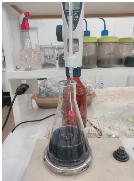
Figura 9. Determinação de COT por combustão via úmida por dicromatometria (Walkley & Black, 1934).
