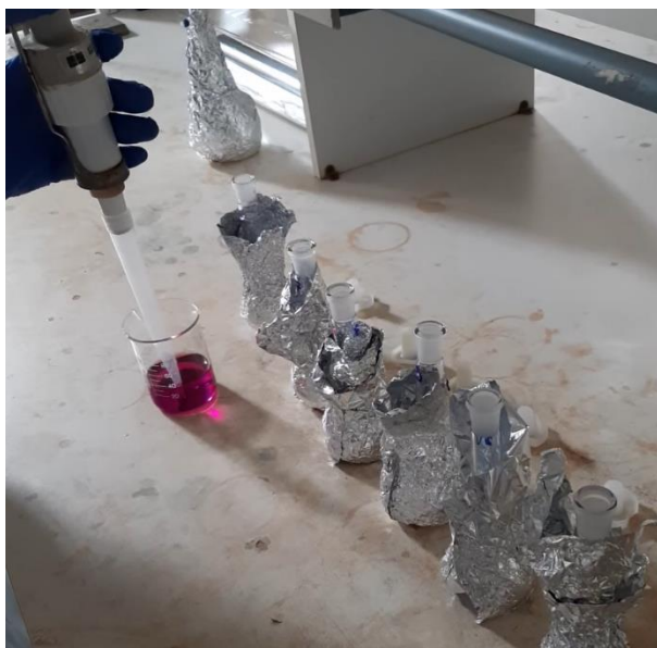
Figura 12. Preparo da curva padrão com a solução contendo 0,00060 \text{ mol L}^{-1} de \text{KMnO}_4
