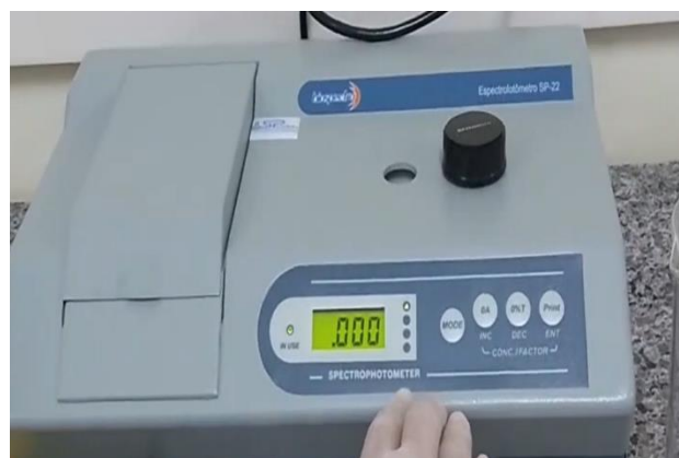
Figura 11. Leitura em espectrofotômetro em comprimento de onda de 565 nm.
