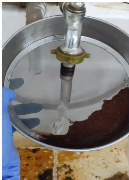
Figura 8. Amostra após agitação, passada em peneira de 53 \mu m.
