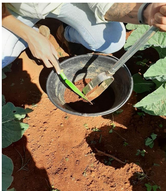
Figura 2. Coleta de 10 subamostras de solo para posterior homogeneização.
