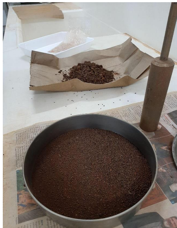
Figura 5. Amostra de solo após passar pela peneira de 2 mm e sem resíduos vegetais.
