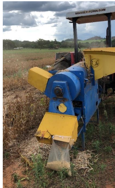
Figura 16 - Trilhadeira em funcionamento.
