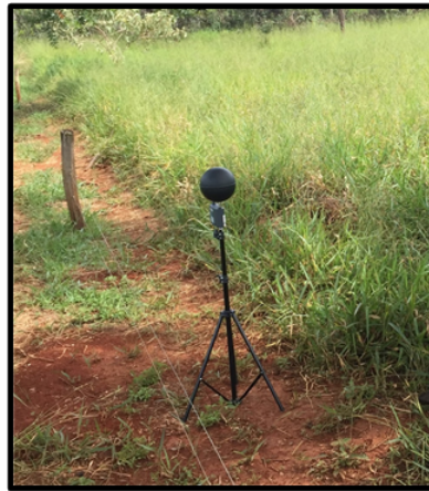
Figura 5 - Termômetro de globo negro utilizado para as coletas das variáveis meteorológicas do microclima sombreado pelas árvores nativas na Unidade Demonstrativa de Criação de Suínos ao Ar Livre - UDCAL/UnB.
