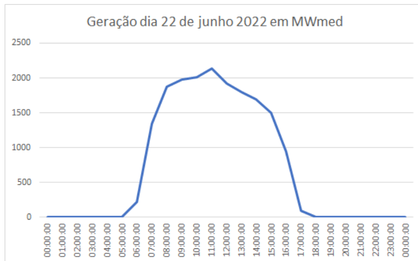
Figura 2.8: Curva horária de Geração Fotovoltaica agregada no Nordeste em 22/06/2022. Fonte: [ONS, 2023]
