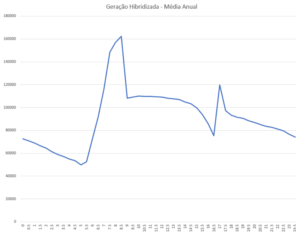
Figura 40: Geração híbrida da usina torre central de 100MW + usina fotovoltaica de 100MWp.
