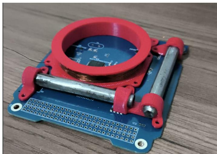
**Figura 3.9.** Etapa de montagem das bobinas.
