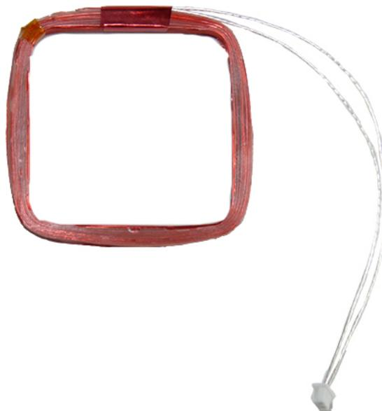
**Figura 2.7.** Magnetorquer compacto MT01 (ERTÜRK, 2022)
