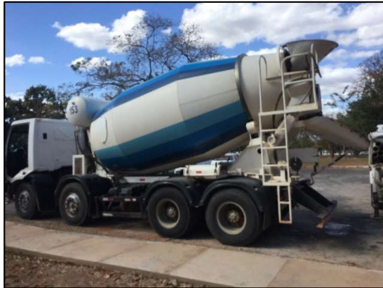
a) Recebimento do concreto
