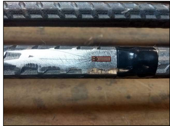
(ii) Extensômetro colado na barra;
