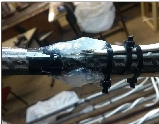
(v) Proteção com silicone;
