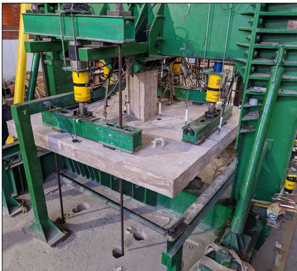
Figura 3.34 – Laje posicionada no pórtico de reação.
