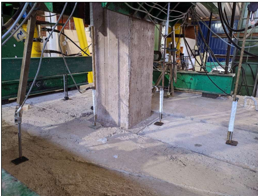
Figura 3.30 – LVDT's posicionados para o ensaio.
