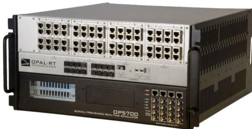
Figura 3.2 – Simulador em tempo real OPAL 5700. Fonte: [SOUZA et al., 2021]
