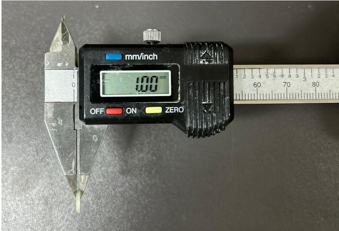
Figura 3 – Conferência da espessura da amostra com um paquímetro digital
