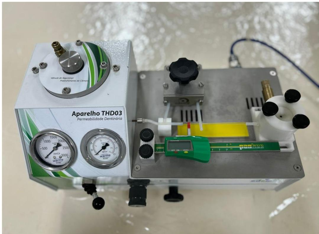
Figura 4 – Aparelho de permeabilidade dentinária THD03
