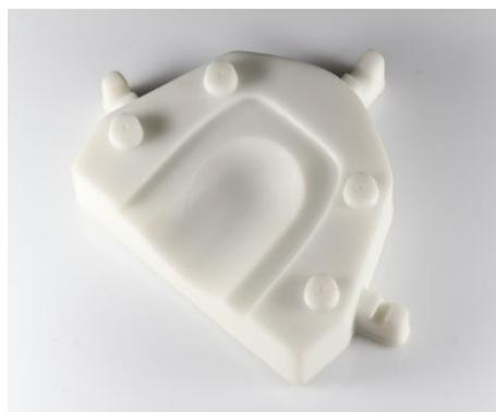
Figura 2: Modelo impresso com a resina 3D Dental Model utilizado para obtenção de moldes de alginato.
