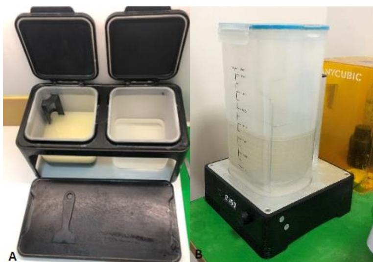
Figura 5: A.) Recipiente com álcool isopropílico, utilizado para lavagem de modelo após impressão 3D. B.) Sistema de lavagem e cura utilizado no modelo após impressão, Wash & Cure 2.0, Anycubic.
