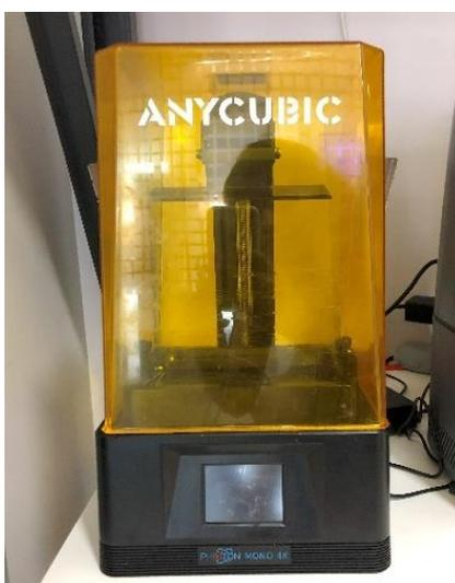
Figura 4: Impressora 3D Photon Mono 4k, da Anycubic, utilizada para impressão do modelo 3D.
