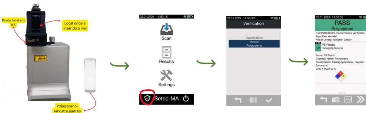
**Figura 7.** Verificação do Raman Portátil Progeny Rigaku. No adaptador de vial em foco 0,5 mm é inserido o tubo de poliestireno de referência. O resultado da verificação definirá se o equipamento está devidamente adequado para uso (“Pass”).
