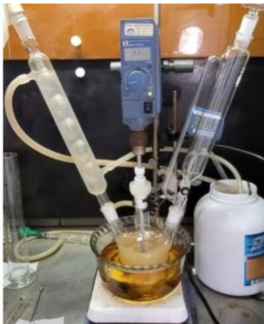
Figura 9. Sistema de epoxidação de óleo de bicho da seda. (DUTRA; SUAREZ; GHESTI, 2022)
