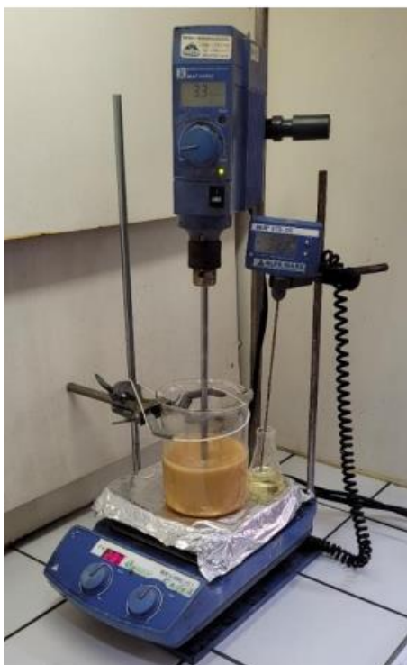
Figura 10. Montagem da reação de saponificação parcial para elaboração de graxas a partir de óleo de mamona, polioli de bicho da seda e base. (DUTRA; SUAREZ; GHESTI, 2022)
