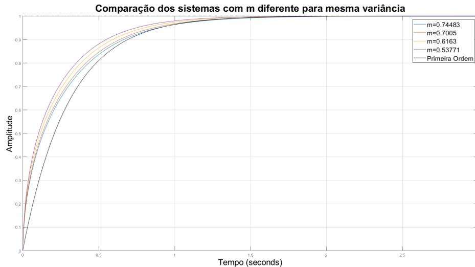
Figura 4.18 – : Comparação da saída degrau para m diferente filtros CRONE
