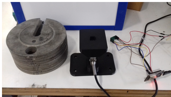
Figura 55 – Montagem para calibração da célula de carga
