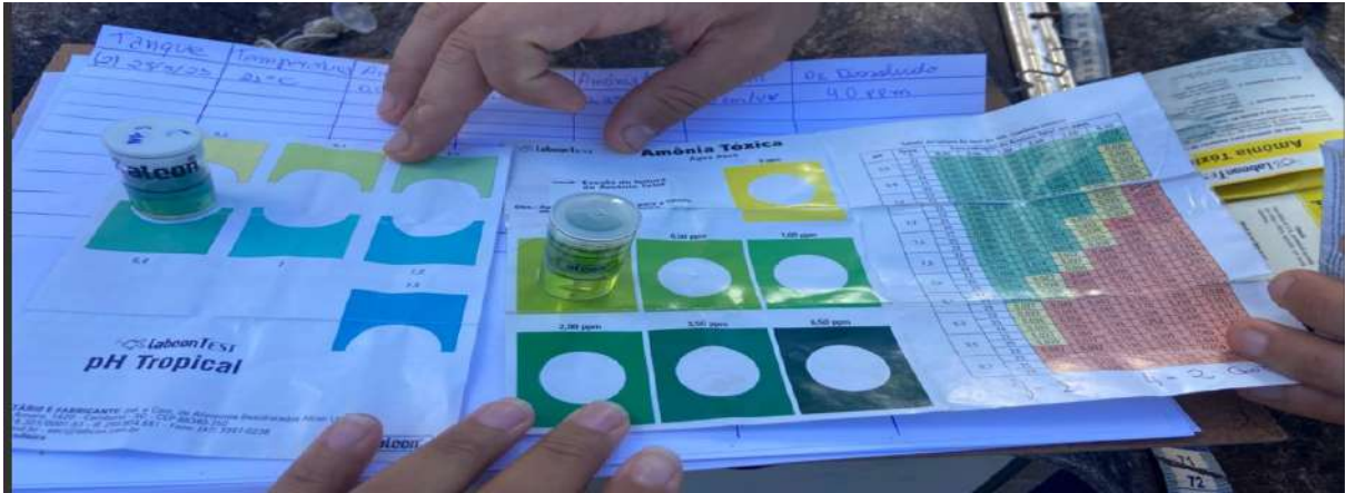
Imagem 13 - Monitorização das condições de água, medição de pH, temperatura e oxigênio dissolvido
