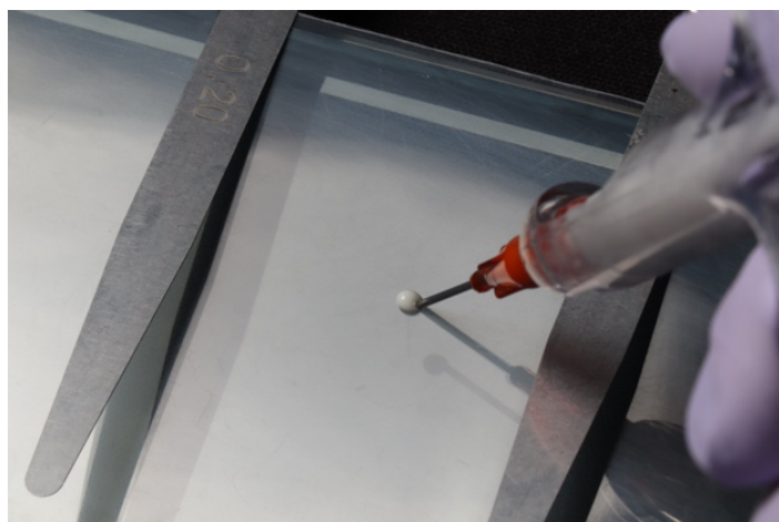
Figura 5: Aplicação com seringa do tipo Centrix
