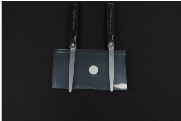
Figura 3: Placa, folha de polipropileno e espaçador
