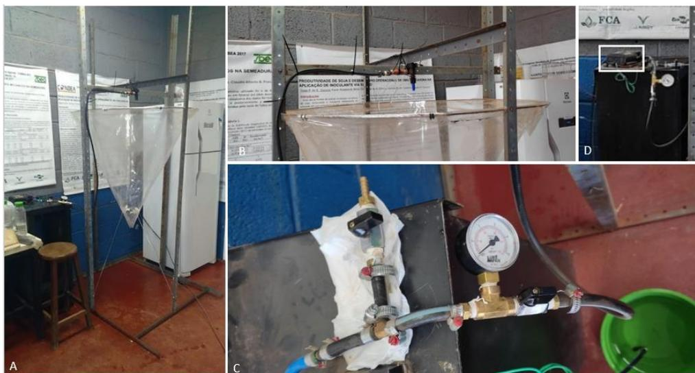
**Figura 3.** a) Detalhes do funil coletor de spray; b) Suporte do bico, com barra e parafusos de regulação da altura; c) Manômetro, regulador de pressão e reservatório de calda; d) Bomba de pressão.
