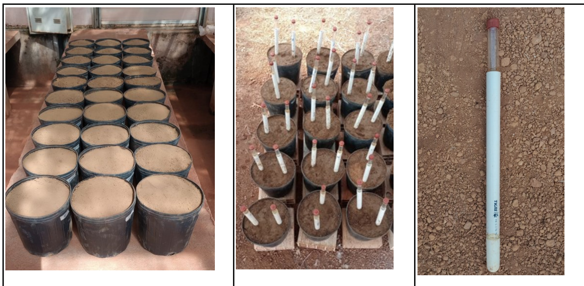
Figura 2. Disposição das unidades experimentais com o solo seco antes da instalação dos tensiômetros (a) e com os tensiômetros instalados (b) e tensiômetro (c).
