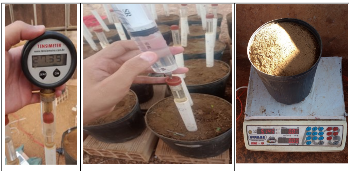
Figura 4. Tensímetro digital de punção (a), restabelecimento da água no tensiômetro utilizando uma seringa (b), pesagem do vaso (c).
