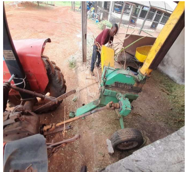
Figura 30: Funcionamento da picadeira ligada a tomada de força do trator.
