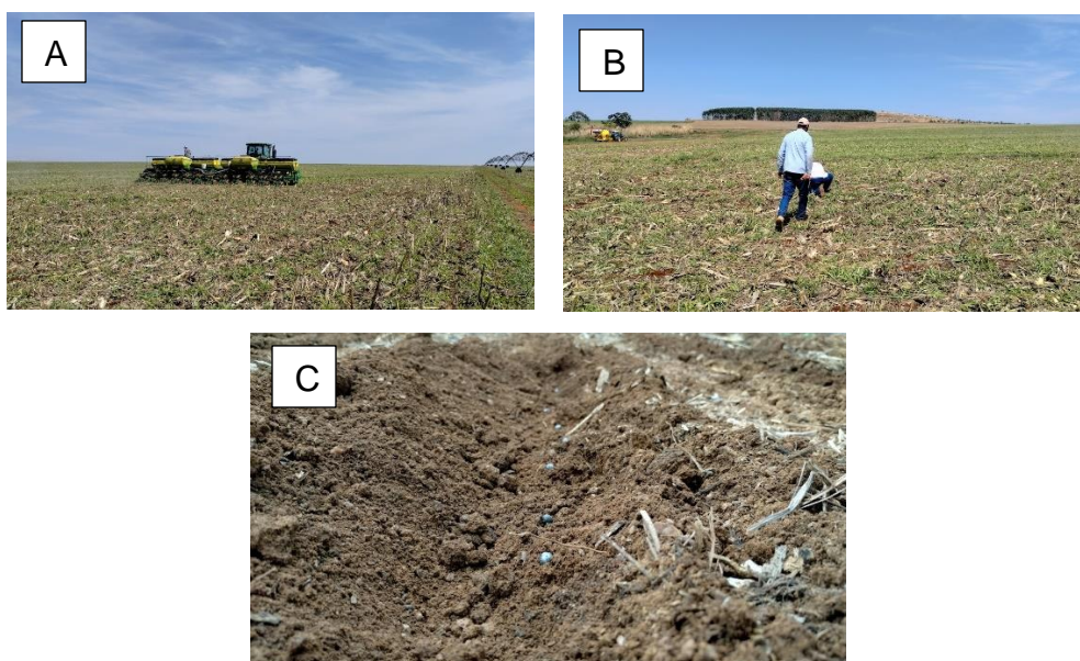
Figura 30 – A) Plantio das primeiras linhas de teste; B) Avaliação da qualidade da semeadura realizada; C) Avaliação da uniformidade e da profundidade na distribuição das sementes e contagem de sementes por metro. Fonte: Próprio autor.
