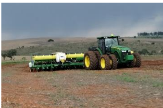
Figura 8 – Conjunto Trator John Deere 8.320R e plantadeira John Deere 2126. Fonte: Próprio autor.
