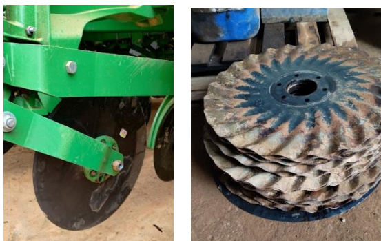
Figura 28 – Troca dos discos ondulados pelos discos de corte planos.
