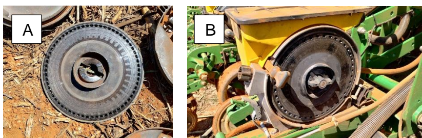
Figura 32 – Troca dos discos de sementes. A) Disco PROMAX 64; B) Disco PROMAX 40. Fonte: Próprio autor.
