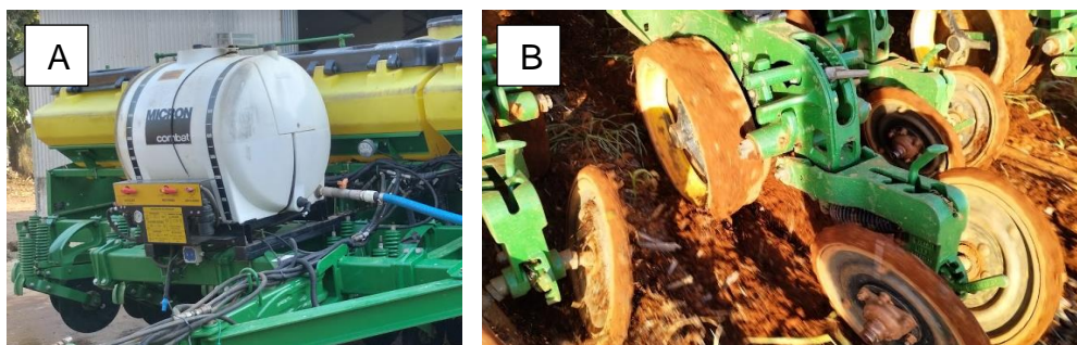
Figura 33 – A) Tanque Micron de 600 litros; B) Aplicação no sulco.
