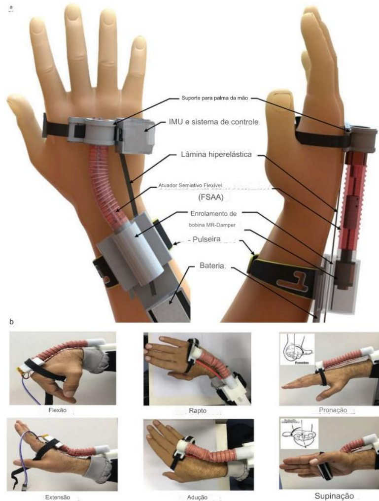
Figura 2.16 – Configuração do sistema SETS: (a) componentes do sistema fixado ao punho; (b) seis movimentos diferentes do punho em que o sistema SETS pode atenuar os tremores.
