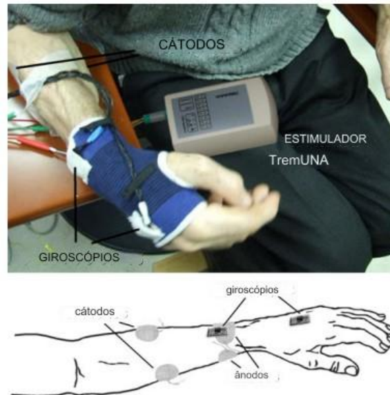
Figura 2.13 – Sistema de supressão de tremor utilizando o estimulador TremUNA.
