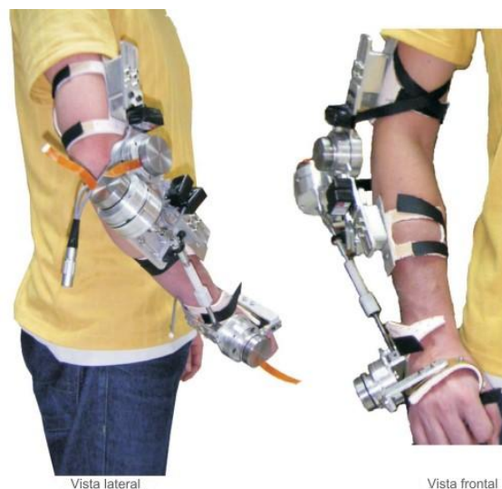
Figura 2.14 – Versão final do WOTAS para supressão de tremores.
