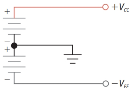
Figura 5.50 – Fonte simétrica com duas baterias em série.
