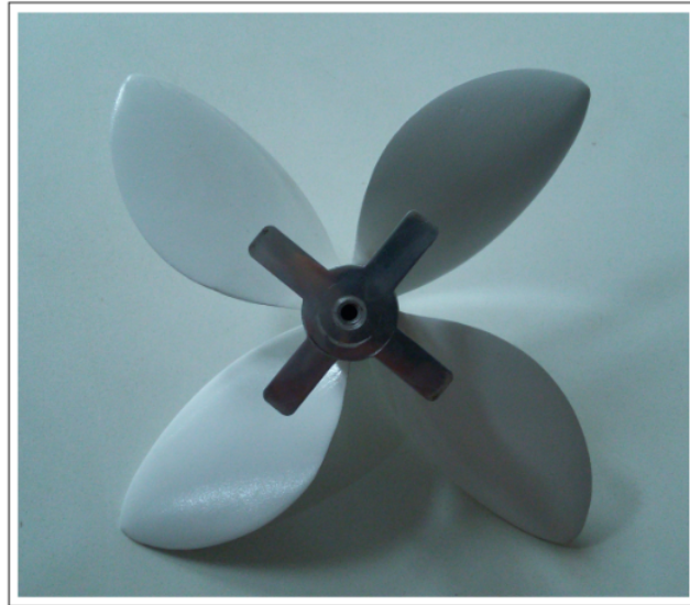
Figura 3.4 – Placas metálicas na base do rotor
