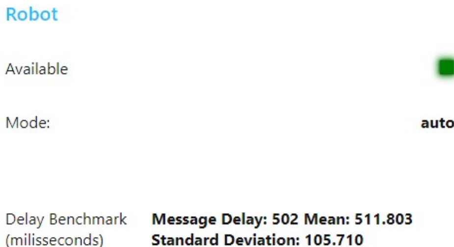
Figura 5.17 – Painel de monitoramento do robô com destaque para o benchmark do delay entre mensagens recebidas pelos subscribers Node-RED MQTT.
