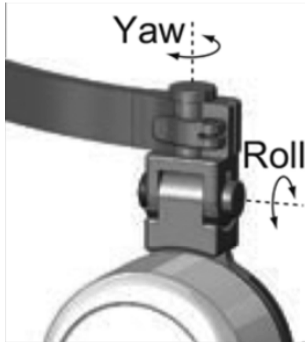
Figura 8.55 – Articulação para o guinar, fonte (TSUKAHARA et al., 2015)
