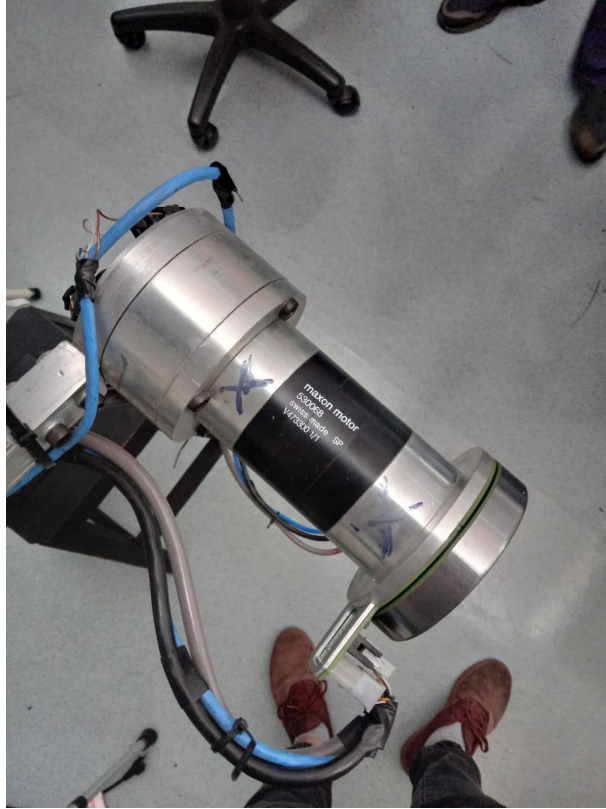
Figura 3.18 – Motores/Redutores usados no exoesqueleto, fonte: Próprio autor
