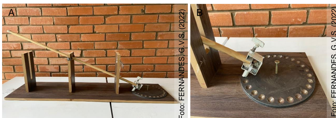
Figura 1. Danificador mecânico utilizado para provocar danos no teste do pêndulo (A) base do disco alveolado (B).
