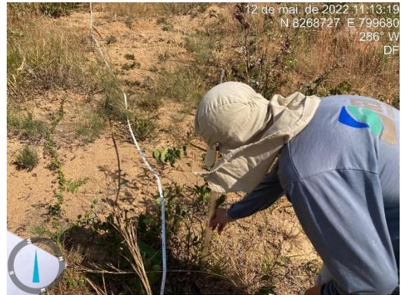
Figura 15. Medição da cobertura do solo.
