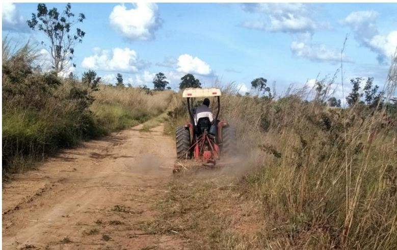
Figura 9. Realização de aceiramento por meio de roçagem. Fonte: GeoLógica 2020.
