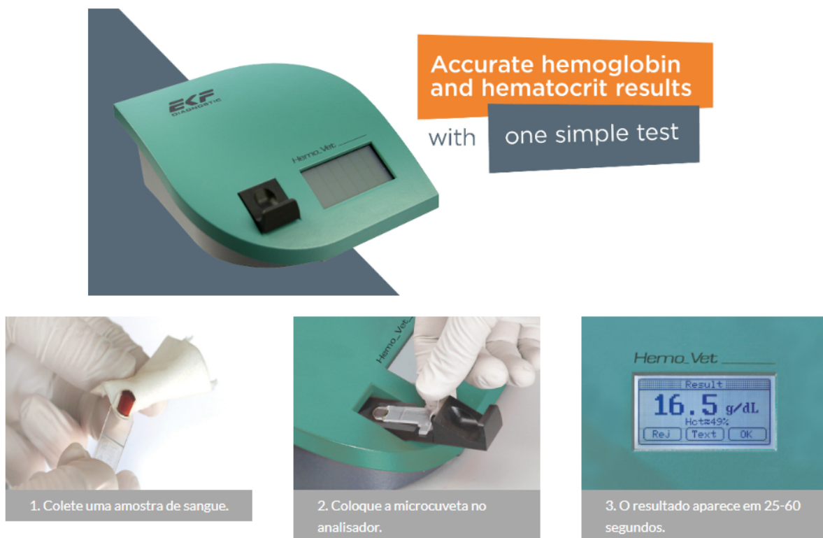
Figura 10. Sensor Hemovet da empresa EFK Diagnostics para análise de hemoglobina e hematócrito. O sensor fica alocado no interior de uma aparelho analisador e é do tipo fotométrico, o analisador possui tamanho compacto de 160 mm x 160mm x 68mm e pesa 700g. Ao inserir uma amostra sanguínea, coletada em uma microcuveta, no interior do aparelho analisador, o resultado aparece no visor entre 25 e 60 segundos (Adaptado de © 2023 EFK Diagnostics).
