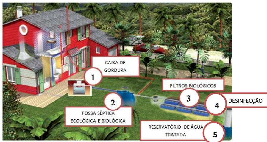
Figura 6: Etapas do funcionamento do sistema. Foto: Sebico Brasil (modificado pela autora).
