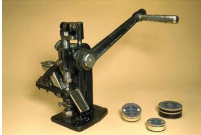
Figura 2 – Fotografia de uma das primeiras máquinas para a produção de comprimidos.
