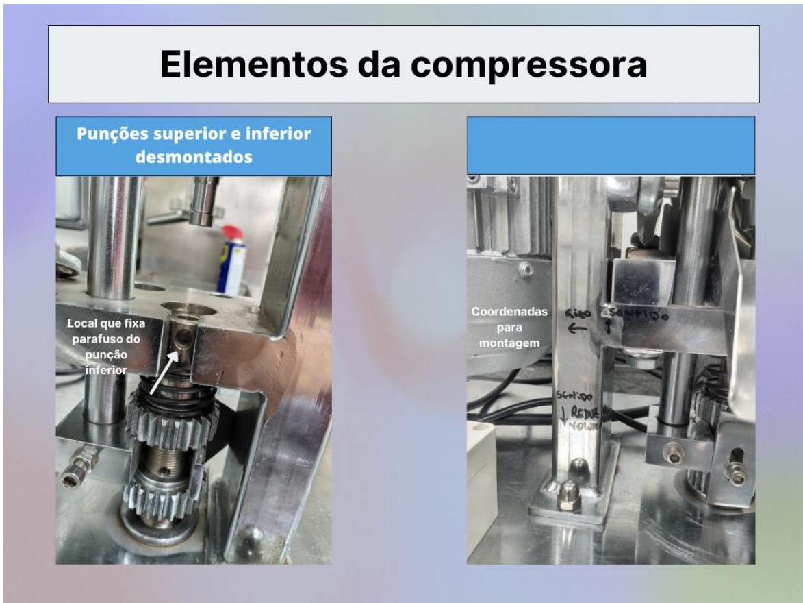
Figura 6.6 - Elementos da compressora
