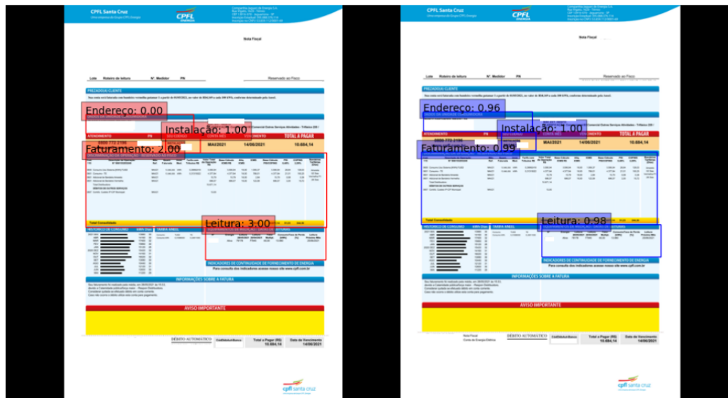
Figura 40 – Comparação em fatura da CPFL com caixas delimitadoras de referência em vermelho, caixas e índices de confiança previstos em azul
