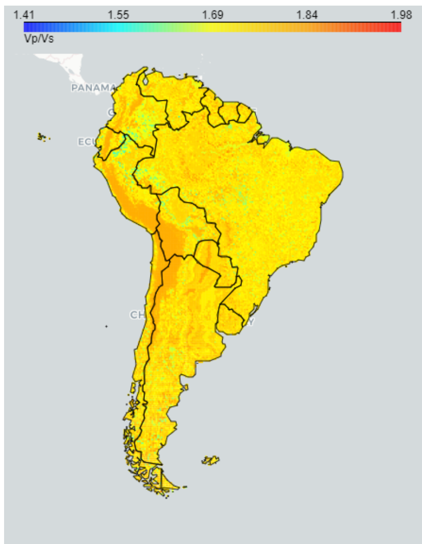
Figura 11 – Mapa gerado ao final do banco de dados, com malha de pontos com o resultado de V_p/V_s .
