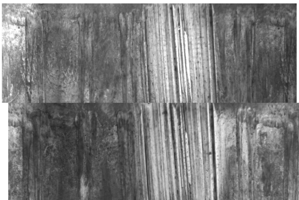
Figura 5.86 – Alinhamento do Projétil 2 (embaixo) com o Projétil 1 (em cima) da Arma 4 - Fonte: Modificado de (SILVINO JUNIOR, 2010)
