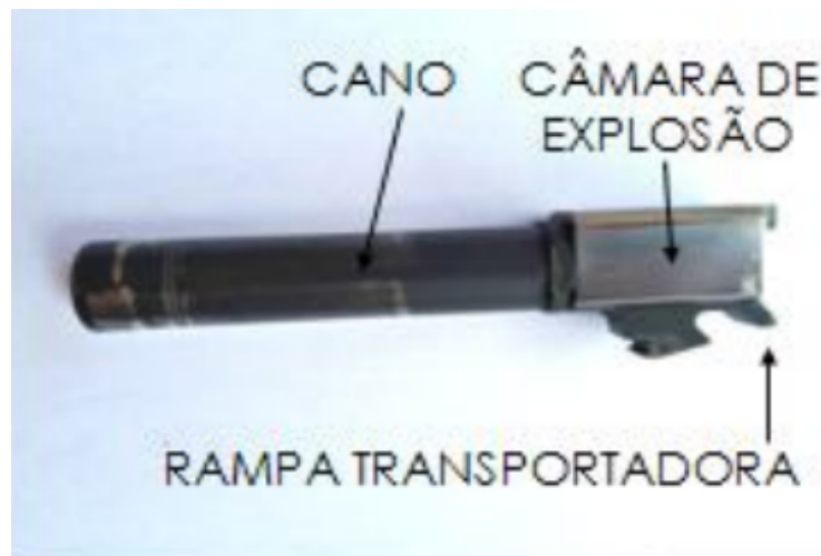
Figura 2.3 – Exemplo de Cano Ligado Câmara de Expansão dos Gases - Fonte: (FREITAS, s.d.)
