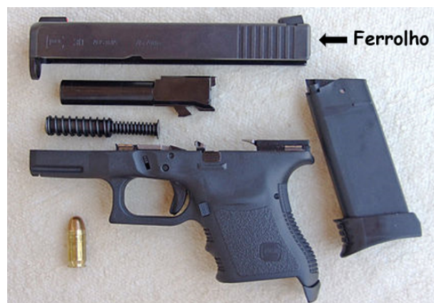
Figura 2.5 – Arma Glock 30 Desmontada - Fonte: (SÁ SOARES, 2002b)
