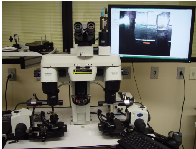
Figura 2.12 – Microscópio de Confronto - Fonte: (SANTOS, L. S. dos, 2015)
