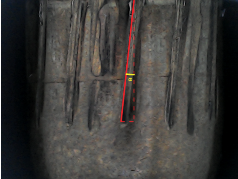
Figura 4.60 – Ângulo de Inclinação da Ranhura de Um Projétil - Fonte: Autor
