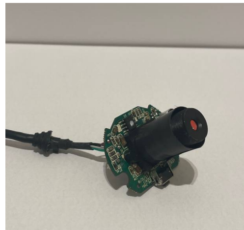
(d) WebCam Aberta Modificada para Microscópio - Fonte: Autor
