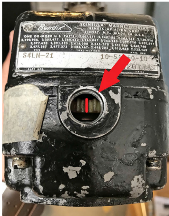
Figura 10 – Engrenagem de sincronização do magneto.
