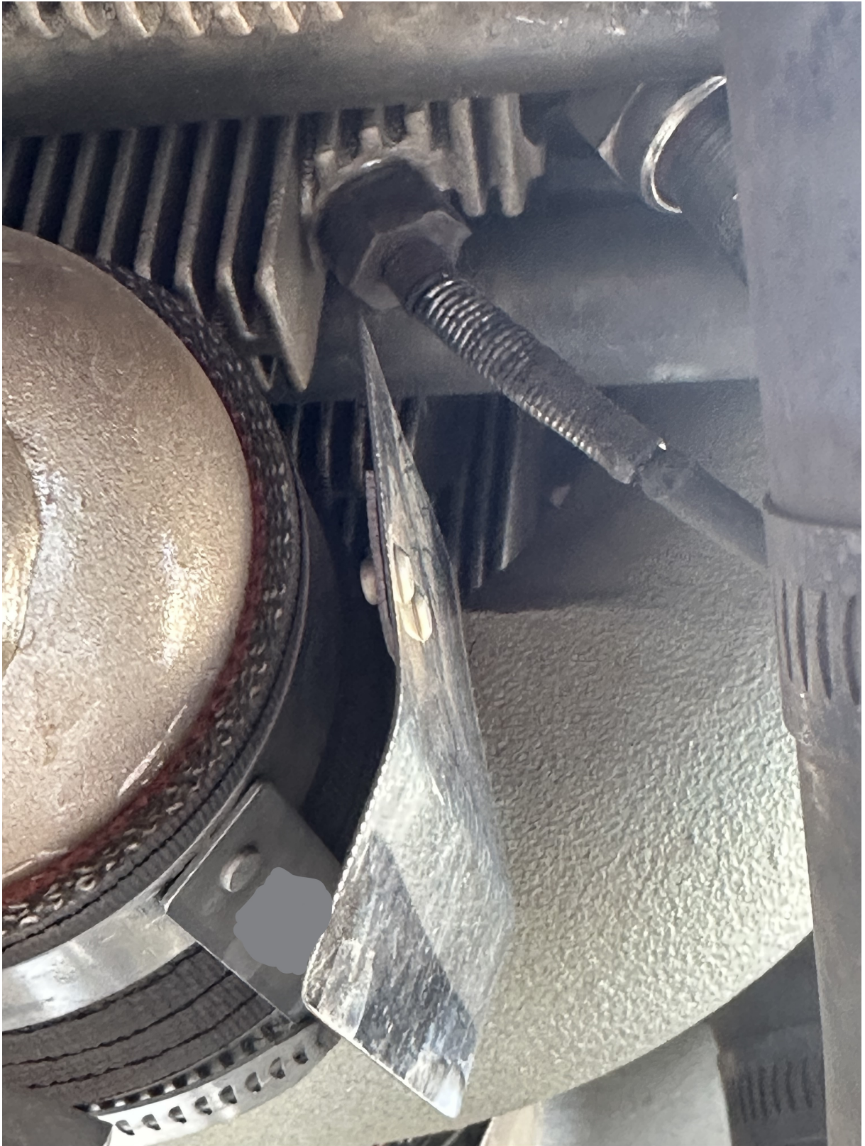
Figura 21 – Montagem de termopar no cilindro do avião.
