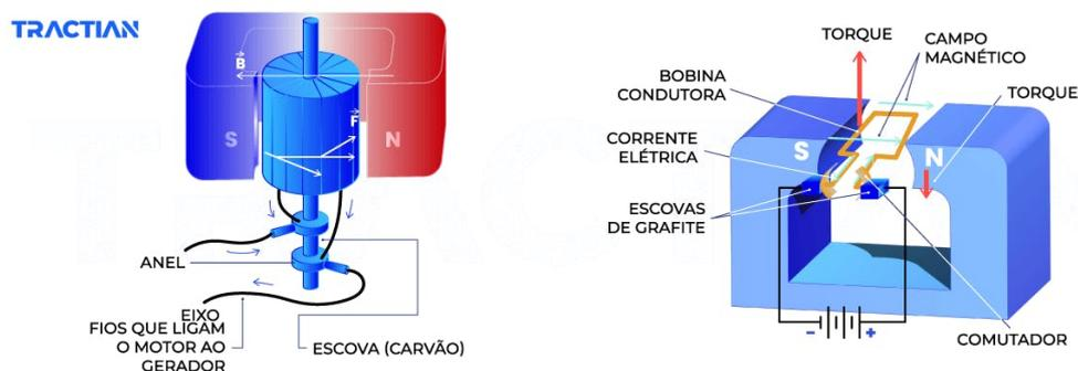
Figura 2.2 – Princípio de funcionamento do motor elétrico
