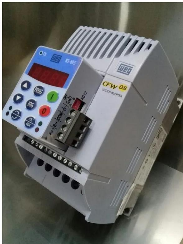
Figura 3.13 – Inversor CFW-08 com módulo KRS-485
