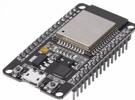
Figura 3.15 – Microcontrolador ESP32
