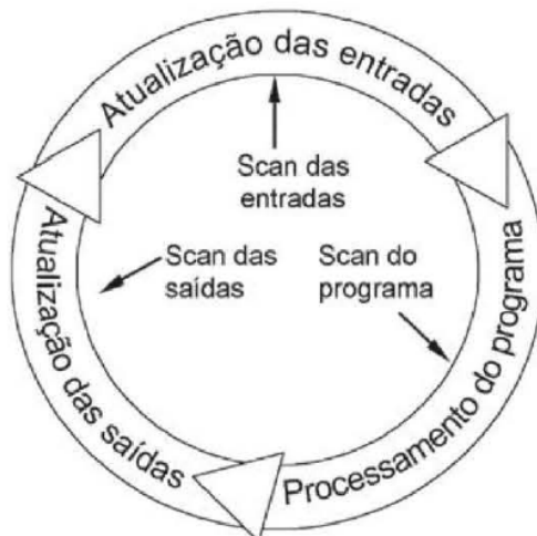
Figura 2.11: Ciclo de scan de um CLP [6].
