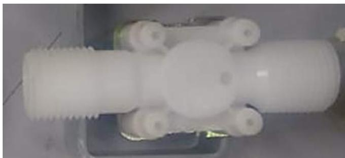
Figura 3.9: Válvula solenoide do bico injetor.
