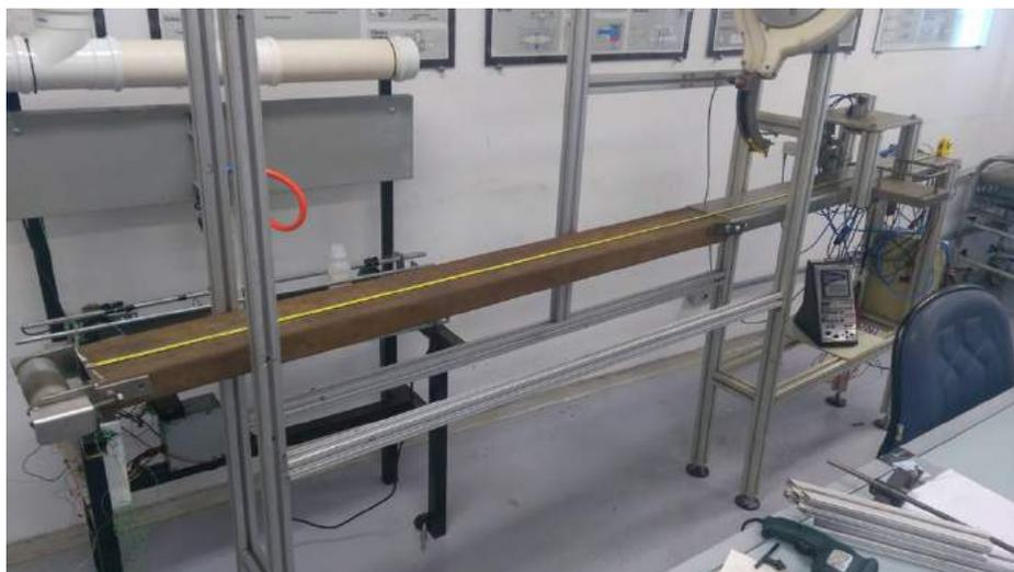
Figura 3.26: Fixação da chapa da esteira.
