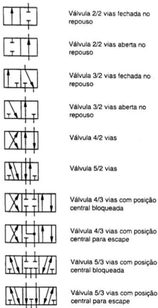
Figura 2.3: Tipos de válvulas direcionais [4].
