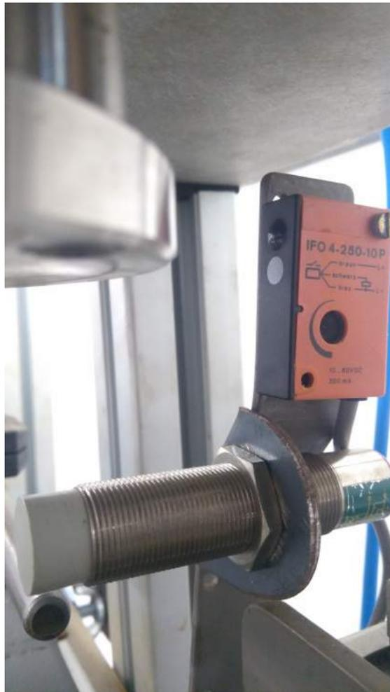
Figura 3.17: Sensores capacitivo e óptico do controle de qualidade.
