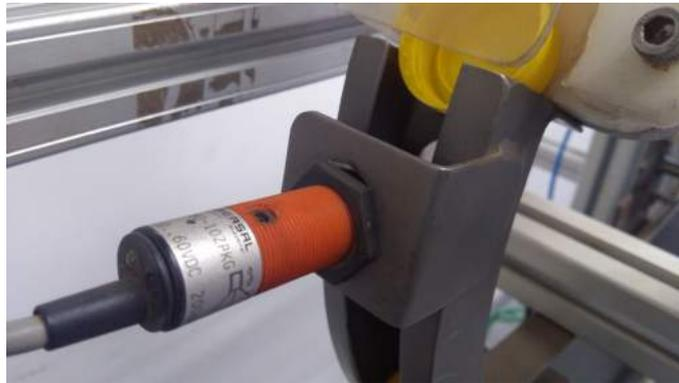
Figura 3.18: Sensor óptico da fila de tampas.
