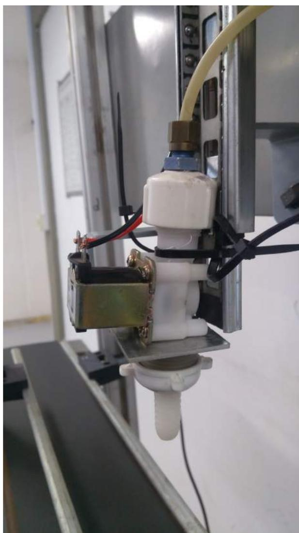
Figura 3.5: Bico Injetor da máquina envasadora.
