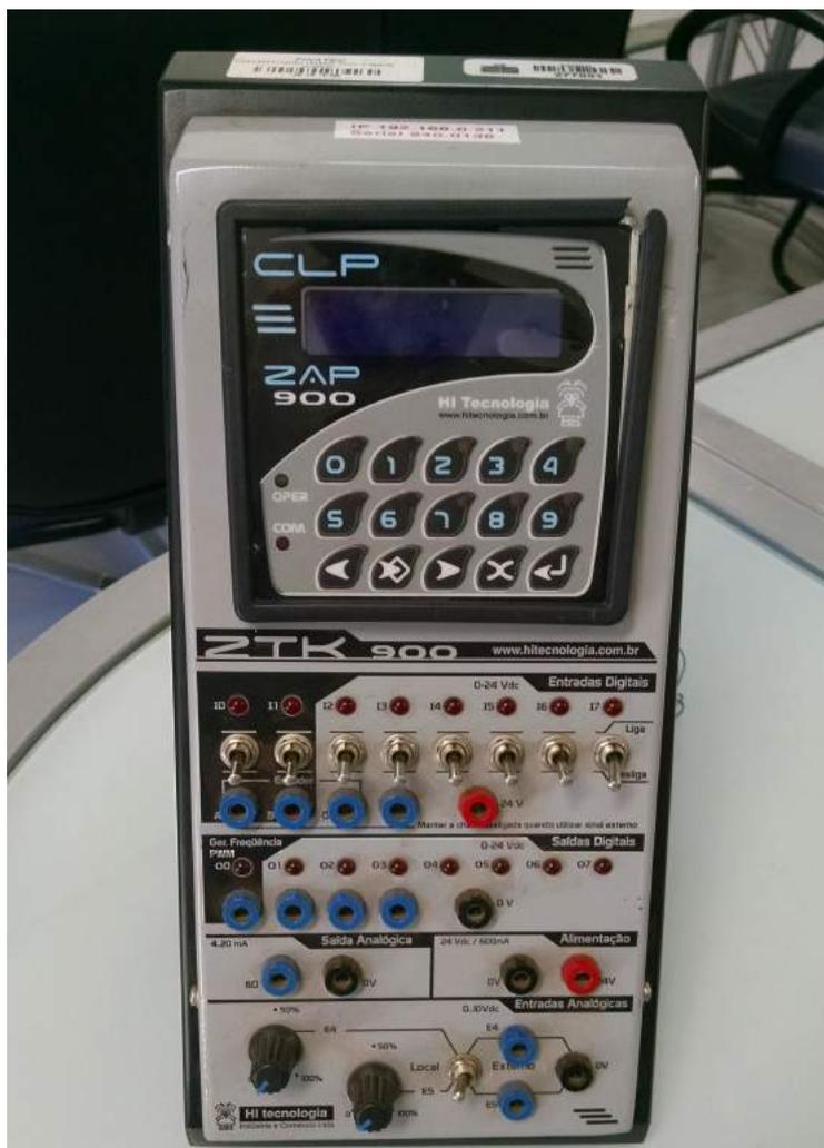
Figura 3.22: CLP ZAP900 acoplado ao painel didático ZTK900.
