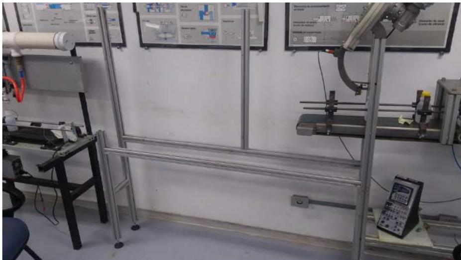
Figura 3.25: Estrutura de fixação montada com o alumínio estrutural.
