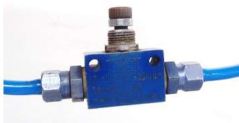
Figura 3.21: Válvula de controle de vazão unidirecional utilizada no controle de qualidade.
