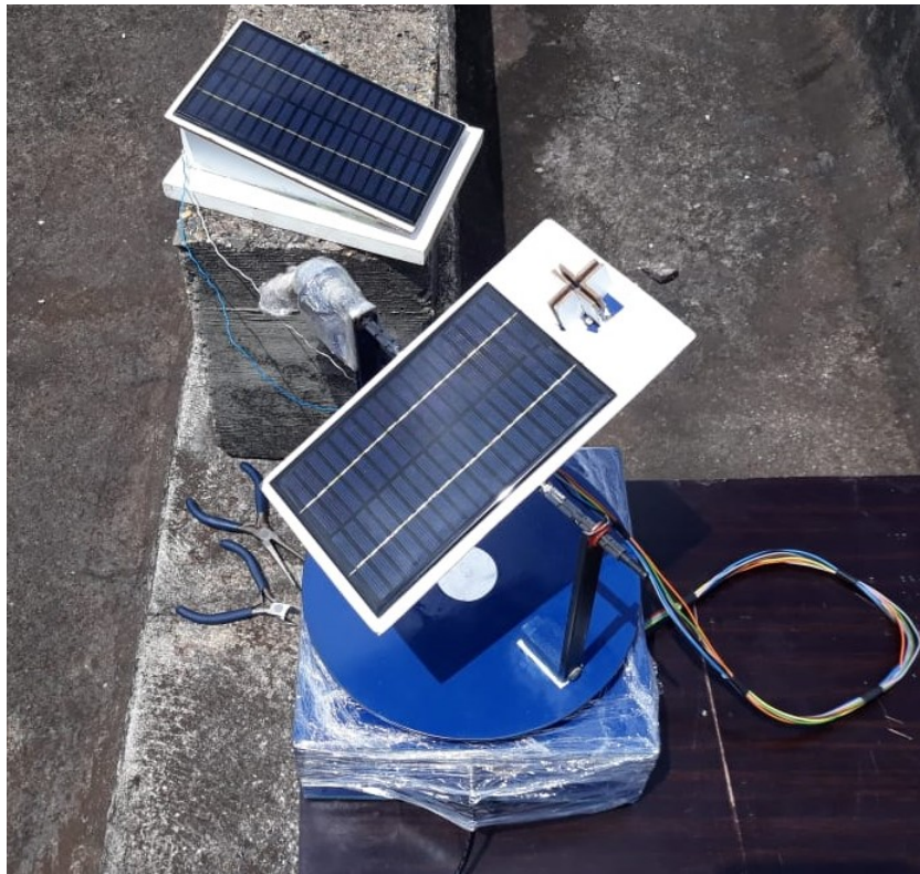
Figura 5.1: Aquisição de dados sendo feita no telhado do prédio SG-11.
